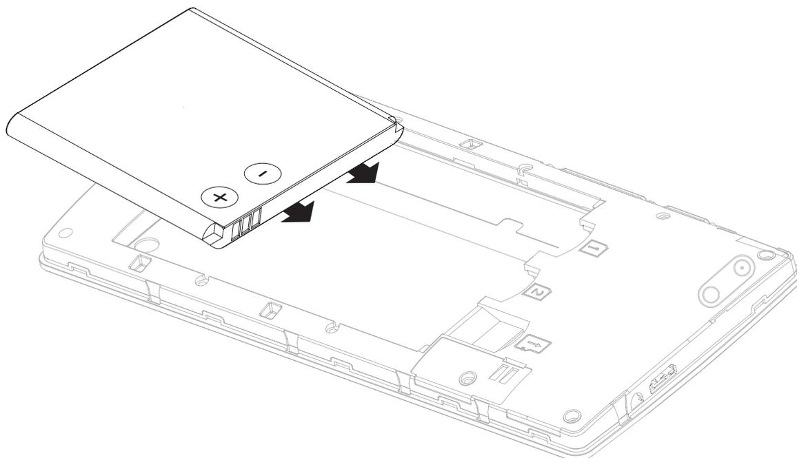
tos de metal do compartimento da bateria seguindo a direção da seta e pressione a parte inferior da bateria para dentro do compartimento;
